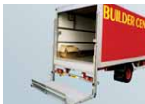
Ascensores de vehículos
