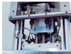
Estación de trabajo doble, con separación fija entre remaches
