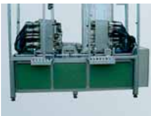
23 módulos de remachado para el montaje de bastidores de ordenadores
