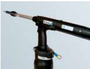
23 módulos de remachado para el montaje de bastidores de ordenadores
